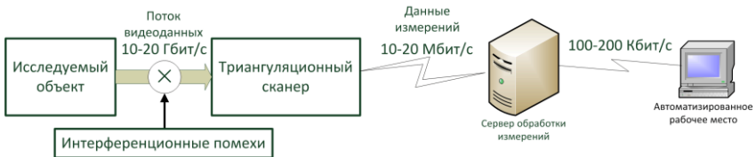
Рис. 2. Схема системы измерения геометрического профиля объекта
