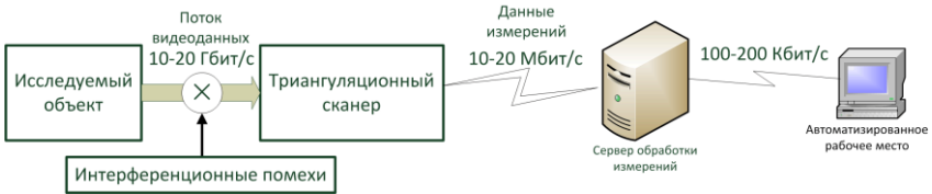
Рис. 2. Схема системы измерения геометрического профиля объекта
